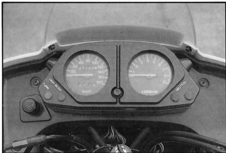
XT 600 Z instrumentpanelet. Det er chokerknappen, som sidder til venstre. Der er informationslamper for blinklys, fjernlys og frigear.
